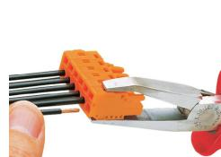
Inserimento del conduttore mediante cacciavite da 3,5 mm; azionamento di CAGE CLAMP® parallelamente rispetto all'ingresso del conduttore.
