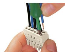
Inserzione del conduttore mediante cacciavite da 3,5 mm: azionamento di CAGE CLAMP® parallelamente rispetto all'ingresso del conduttore.
