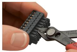
Codifica di un connettore femmina con rimozione del perno(i) di codifica.
