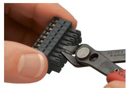
Codifica di un connettore femmina con rimozione del perno(i) di codifica.
