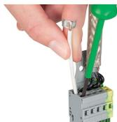
Inserire la terminazione schermata nel connettore femmina usando l'utensile.
