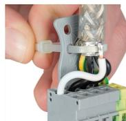
Fissare entrambi i cavi schermati e la connessione schermata sulla piastra anti-strappo usando le fascette fermaccavi.
