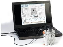
Configurazione tramite software per configurazione WAGO Interface
