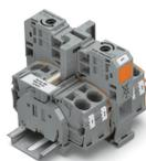
Messa in comunicazione dei morsetti POWER CAGE CLAMP da 35 mm<sup>2</sup> (2 AWG) con i morsetti da 10/16 mm<sup>2</sup> (8/6 AWG) delle serie 2010 e 2016 TOPJOB® S tramite ponticelli di riduzione (non applicabile per le serie 2016-76xx e 2016-77xx).
