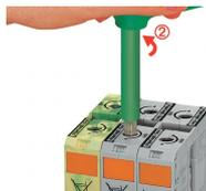
Connessione conduttore – fase 3: Una breve rotazione in senso antiorario ri- lascia il fermo. Quando sbloccato, la chia- vetta a T ruota in senso orario serrando saldamente il conduttore.
