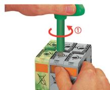
Connessione conduttore – fase 1: Ruotare la chiave a T in senso antiorario fino all'arresto . Poi, premere il tasto di bloccaggio arancione. La morsa resta bloccata in posizione aperta per un cablaggio a mani libere.
