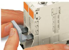
Messa in comune del potenziale con un ponticello orizzontale: inserire il ponticello sul foro d'ingresso del conduttore, prima della connessione del conduttore. La sezione nominale resta inalterata.
