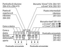
Collegamento a ponte dei morsetti per montaggio su guida da 6 mm<sup>2</sup>/10 AWG (serie 282) a 1,5 mm<sup>2</sup>/16 AWG (serie 279) mediante ponticelli di riduzione.
