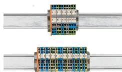
Con una larghezza del morsetto di soli 5 mm, è possibile realizzare una larghezza effettiva di soli 2,5 mm per morsetti dal potenziale uguale o diverso per conduttori da 0,08 mm<sup>2</sup> a 2,5 mm<sup>2</sup> (da 28 a 14 AWG).
