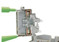
Test con portafusibile in posizione aperta (senza tensione)
