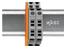
I morsetti per fusibile o sezionatori con una larghezza di 8 mm, possono essere montati adiacenti. Al termine di un gruppo, o se non vi è un morsetto sezionatore o con fusibile adiacente, deve essere usata una piastra intermedia o terminale.
