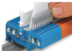
Collegamento a ponte di morsetti sezionatori con cablaggio frontale tramite barre di ponticelli a pettine servendosi di un utensile di montaggio a 10 poli
