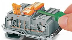
Lo scollegamento a coltello pivotante indica chiaramente lo stato del circuito con posizioni definite e dentellate "ON" "OFF".
