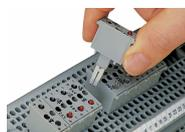
Allo stesso modo dei ponticelli del tipo a innesto, questi moduli con indicatore LED e al neon sono semplicemente innestati a spinta nella sede di contatto delle barre di corrente per due morsetti passanti adiacenti, fornendo i seguenti vantaggi: Compatibilità con tutti i morsetti passanti della serie 280 Facilità di adattamento per i sistemi esistenti
