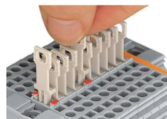
Estrazione manuale della spina di sezionamento.
