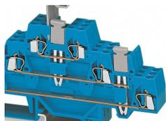
Un ponticello verticale mette in comune il potenziale dei piani inferiore e superiore creando un morsetto passante per 6 conduttori in una custodia. Due morsetti a tre piani adiacenti possono essere messi in comune insieme sullo stesso piano usando un ponticello orizzontale a innesto.
