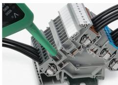
Test tramite tester indicatore di tensione direttamente sulla barra di corrente.
