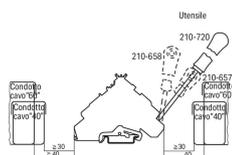
Distanza di fissaggio minima: morsetti - canaletta
