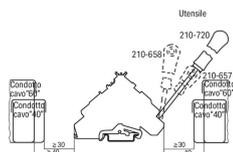
Distanza di fissaggio minima: morsetti - canaletta
