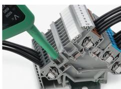
Test tramite tester indicatore di tensione
