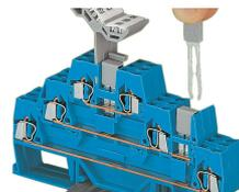
Un ponticello verticale mette in comune il potenziale dei piani inferiore e superiore creando un morsetto passante per 6 conduttori in una custodia. Due morsetti a tre piani adiacenti possono essere messi in comune insieme sullo stesso piano usando un ponticello orizzontale a innesto.
