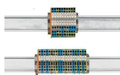
Con una larghezza del morsetto di soli 5 mm, è possibile realizzare una larghezza effettiva di soli 2,5 mm per morsetti dal potenziale uguale o diverso per conduttori da 0,08 mm<sup>2</sup> a 2,5 mm<sup>2</sup> (da 28 a 14 AWG).
