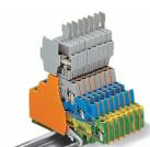
Se i morsetti a tre piani sono usati con una spina fusibilata (larghezza 6 mm) inserita nella sede del piano (alto), la larghezza aggiuntiva della serie 280 (larghezza 5 mm) può essere compensata tramite una piastra intermedia (spessa 1,1 mm).
