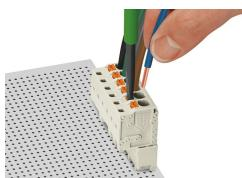
Inserimento/rimozione di un conduttore mediante cacciavite da 3,5 mm: azionamento Push-in CAGE CLAMP® in condizione accoppiata.
