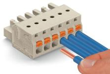
Inserimento/rimozione di un conduttore mediante cacciavite da 3,5 mm: azionamento Push-in CAGE CLAMP® in condizione accoppiata.
