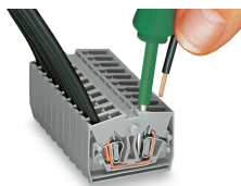
Connessione CAGE CLAMP® Inserimento di un conduttore. Quando sono utilizzate delle boccole, il morsetto deve essere di una dimensione inferiore rispetto alla sezione nominale del conduttore.
