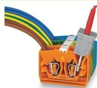
Test tramite contatto con la molla del CAGE CLAMP® (limitazione a 0,5 A e tensione di prova di 48 V) – punte di prova non protette dal contatto accidentale.
