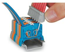
Test tramite contatto con la molla del CAGE CLAMP® (limitazione a 0,5 A e tensione di prova di 48 V) – punte di prova non protette dal contatto accidentale.
