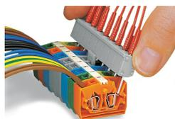
Test tramite contatto con la molla del CAGE CLAMP® (limitazione a 0,5 A e tensione di prova di 48 V) – punte di prova non protette dal contatto accidentale.
