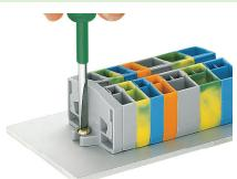
Montaggio e fissaggio di una morsettiera direttamente alla piastra mediante flange avvitabili.
