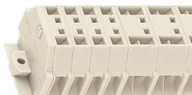
Morsetteria con flange di fissaggio, per montaggio a vite o tipo di montaggio simile, foro di fissaggio di 3,2 mm di diametro (anche per piedi di fissaggio 209-123 per guida DIN 35)
