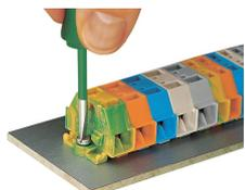
Montaggio e fissaggio di una morsetteria direttamente alla piastra mediante flange avvitabili.
