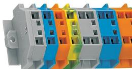
Morsettiera con flange di fissaggio, per montaggio a vite o tipo di montaggio simile, foro di fissaggio di 3,2 mm di diametro (anche per piede di fissaggio 209-123 per guida DIN 35)
