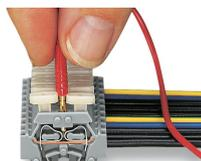
Test con una spina di prova di Ø 2 mm – contatto diretto.
