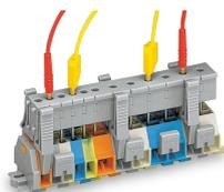
Test attraverso moduli per spina di prova innestati sulla morsettiera: cablata o non cablata. Dato che il contatto è effettuato con l'unità CAGE CLAMP® (acciaio per molla), questo tipo di test è limitato a un massimo di 0,5 A.
