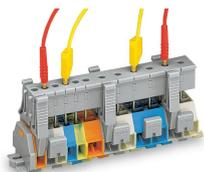
Test attraverso moduli per spina di prova innestati sulla morsettieria: cablata o non cablata. Dato che il contatto è effettuato con l'unità CAGE CLAMP® (acciaio per molla), questo tipo di test è limitato a un massimo di 0,5 A.
