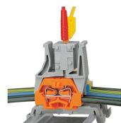
Test attraverso moduli per spina di prova innestati sulla morsetteria: cablata o non cablata. Dato che il contatto è effettuato con l'unità CAGE CLAMP® (acciaio per molla), questo tipo di test è limitato a un massimo di 0,5 A.
