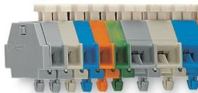
Morsettieria con piedino di fissaggio a scatto, per lamiere spesse da 0,6 mm a 1,2 mm, foro di fissaggio Ø 3,5 mm (anche per guida di alluminio 210-154 o con piede di montaggio 209-120 per guida DIN 35)
