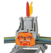
Test attraverso moduli per spina di prova innestati sulla morsettiera: cablata o non cablata. Dato che il contatto è effettuato con l'unità CAGE CLAMP® (acciaio per molla), questo tipo di test è limitato a un massimo di 0,5 A.
