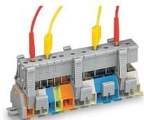
Test attraverso moduli per spina di prova innestati sulla morsetteria: cablata o non cablata. Dato che il contatto è effettuato con l'unità CAGE CLAMP® (acciaio per molla), questo tipo di test è limitato a un massimo di 0,5 A.
