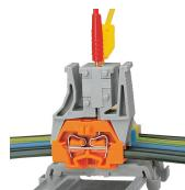
Test attraverso moduli per spina di prova innestati nella morsettiera: cablata o non cablata. Dato che il contatto è effettuato con l'unità CAGE CLAMP® (acciaio per molla), questo tipo di test è limitato a un massimo di 0,5 A.
