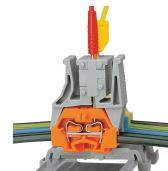
Test attraverso moduli per spina di prova innestati sulla morsettiera: cablata o non cablata. Dato che il contatto è effettuato con l'unità CAGE CLAMP® (acciaio per molla), questo tipo di test è limitato a un massimo di 0,5 A.
