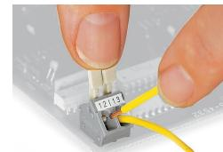
Inserimento/rimozione di un conduttore mediante leve azionate a mano - serie 256.
