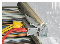
Test con moduli per spina di prova.
