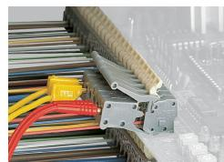
Test con moduli per spina di prova.
