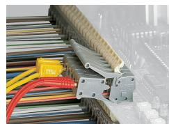
Test con moduli per spina di prova.
