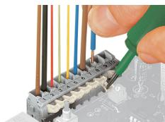
Inserimento/rimozione di un conduttore (serie 255)
