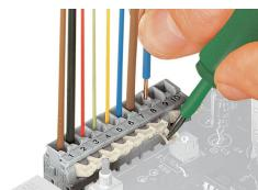
Inserimento/rimozione di un conduttore (serie 255)
