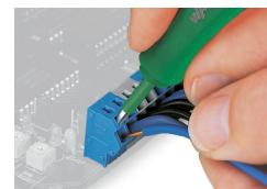
Rimozione di un conduttore rigido.
