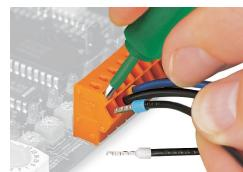
Inserimento/rimozione del conduttore con boccolla.
