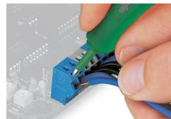
Rimozione di un conduttore rigido.
