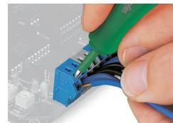
Rimozione di un conduttore rigido.
